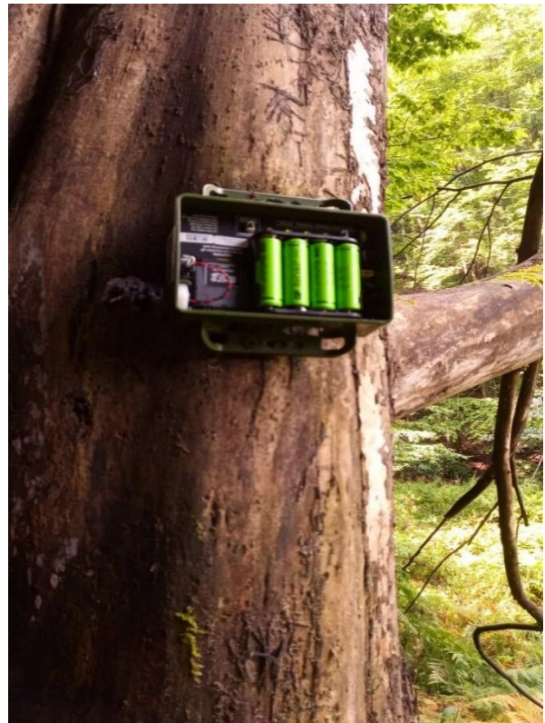
Рис.2. Звукозаписуючий пристрій в лісі
